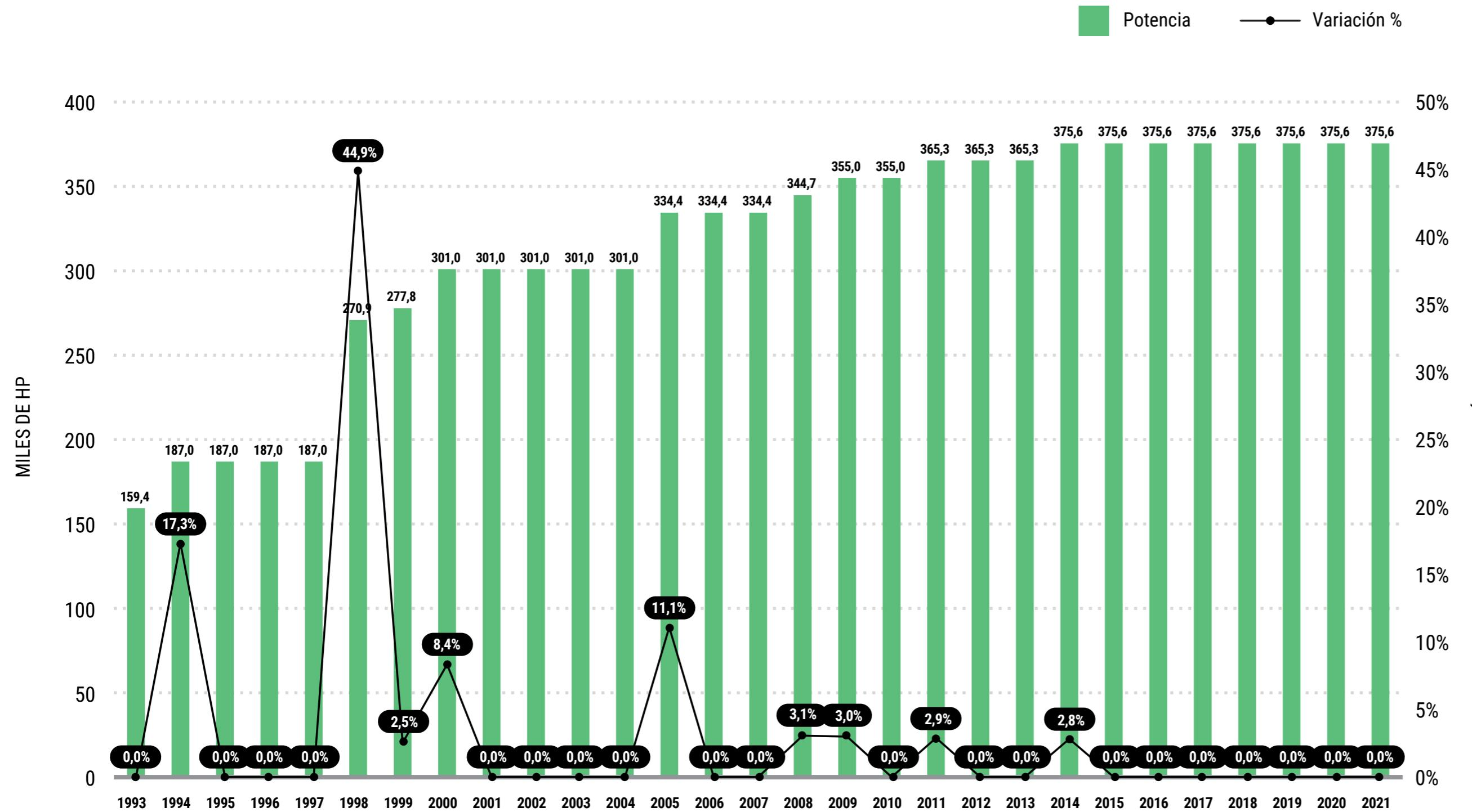
Sobre cada gasoducto del país, y a una distancia de aproximadamente 120 km se ubica una Planta Compresora, la cual tiene grandes equipos de impulsión (compresores) que le brindan al gas la fuerza de empuje necesaria para recorrer el gasoducto hasta la siguiente Planta, y así sucesivamente hasta los centros de consumo. La suma de potencia de los compresores de todas las Plantas Compresoras del Sistema Licenciado de Transporte del país conforma la potencia instalada total país.
